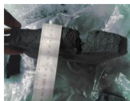
粉碎前 约170×150×t50mm Before crushing
