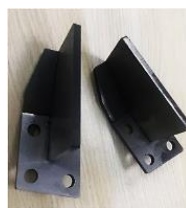
④ 两个桨叶可选用耐磨性树脂 或碳化钨制作
