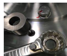
⑦ 固定螺栓每颗螺母都有 标线作记号
